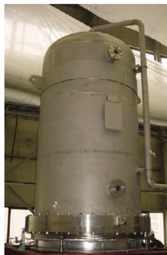
•使用压力容器制造技术的CVD 反应塔
